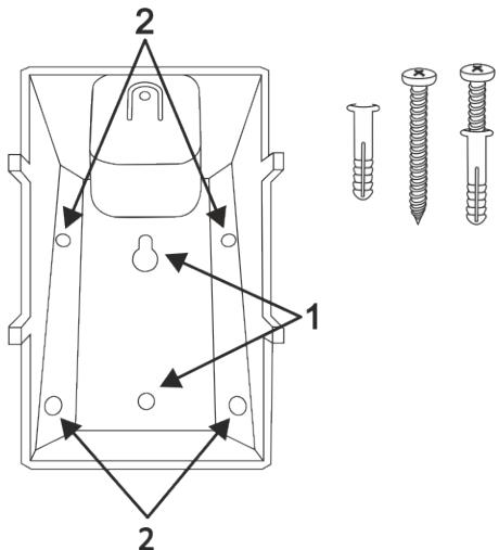
2. Вставьте выступы кронштейна в пазы на задней панели датчика и аккуратно сдвиньте датчик вниз до щелчка.
