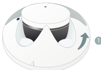
Рисунок 6.2 – Вскрытие корпуса датчика
