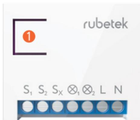
S<sub>1</sub>, S<sub>2</sub>, S<sub>x</sub> – разъёмы кнопок выключателя
